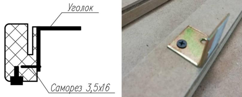
15. Установить планки в проем. Закрепить к брусу 40x38 при помощи саморезов 3,5x16.
